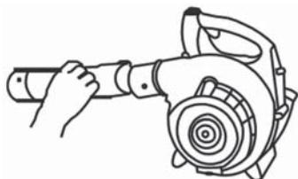
Umístěte foukací trubku B do stroje otáčením
